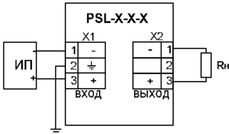
Рисунок 5.2 – Типовая схема подключения Блоков
