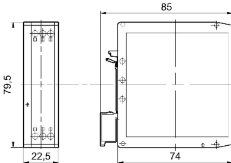
Рисунок 5.1 – Габаритные и установочные размеры Блоков
